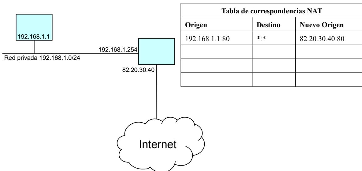
Figura 12: Servidor Web en 192.168.1.1 expuesto a Internet
