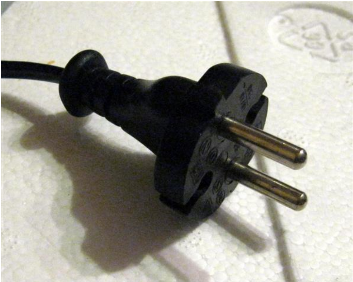
Figura 38: Enchufe schuco válido para equipo con doble aislamiento (sin tierra)
