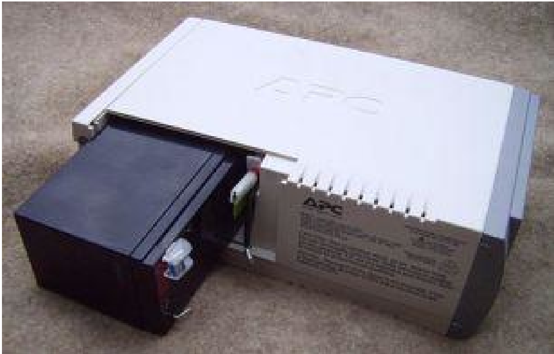
Figura 44: Batería interna de un SAI
