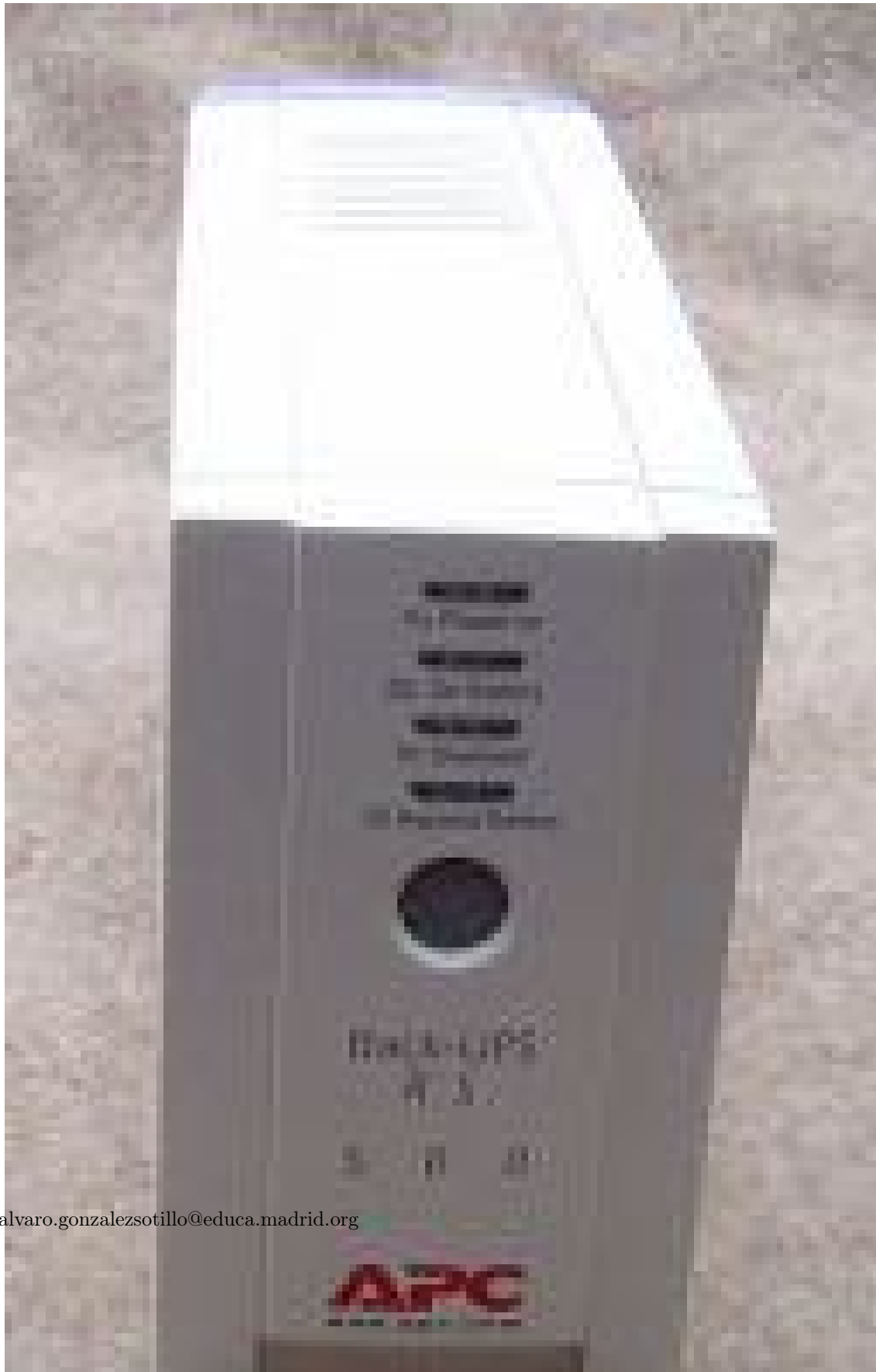
Cuadro 3: Vista frontal y trasera de un SAI tipo SOHO
