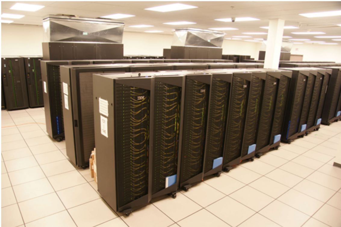
Figura 18: El IBM iDataPlex funciona en clúster, como un único ordenador, aunque está formado por servidores independientes. El de la foto tiene unas 30000 CPU en total
